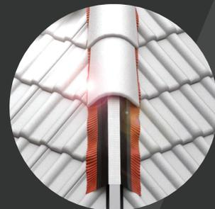
Аэроэлемент конька-хребта является одним из важнейших компонентов для защиты и долговечности крыши. Применяется для обустройства вентиляции конька и хребта кровель из штучной черепицы и профилированных метериалов (композитных материалов, металлочерепицы, профнастила) и защищает от задувания дождя, снега и града в подкровельное пространство.
